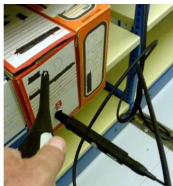
Fig. 25 : Mesures simultanées d'humidité et température dans les documents et à l'extérieur.
