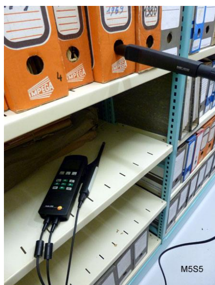
Fig.21 : Mesures ponctuelles d'humidité à l'extérieur et dans les documents.
