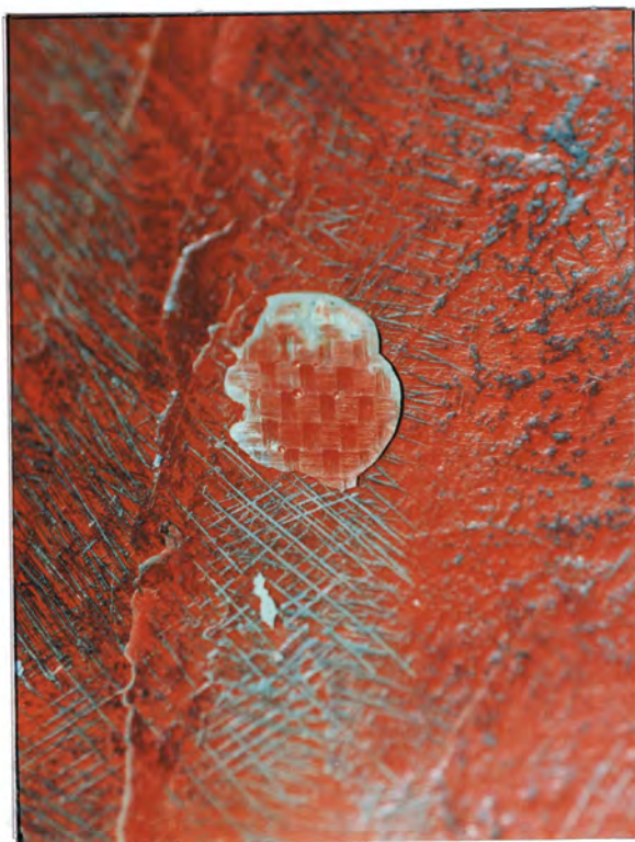
Fig.68: Perte de la couche de gel coat colorée
