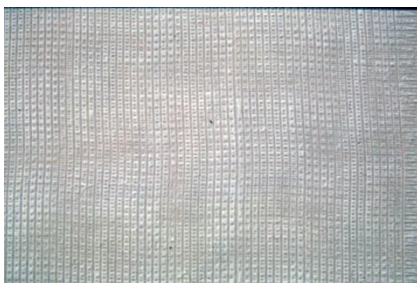
Photo 172, Structure de la colle de doublage.
