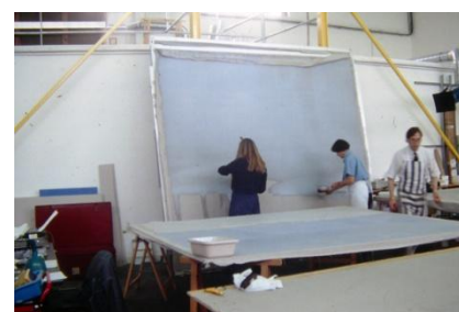
Photo161, Préparation de la toile de doublage, encollage de la toile de doublage de Plexitol B 500 dilué
