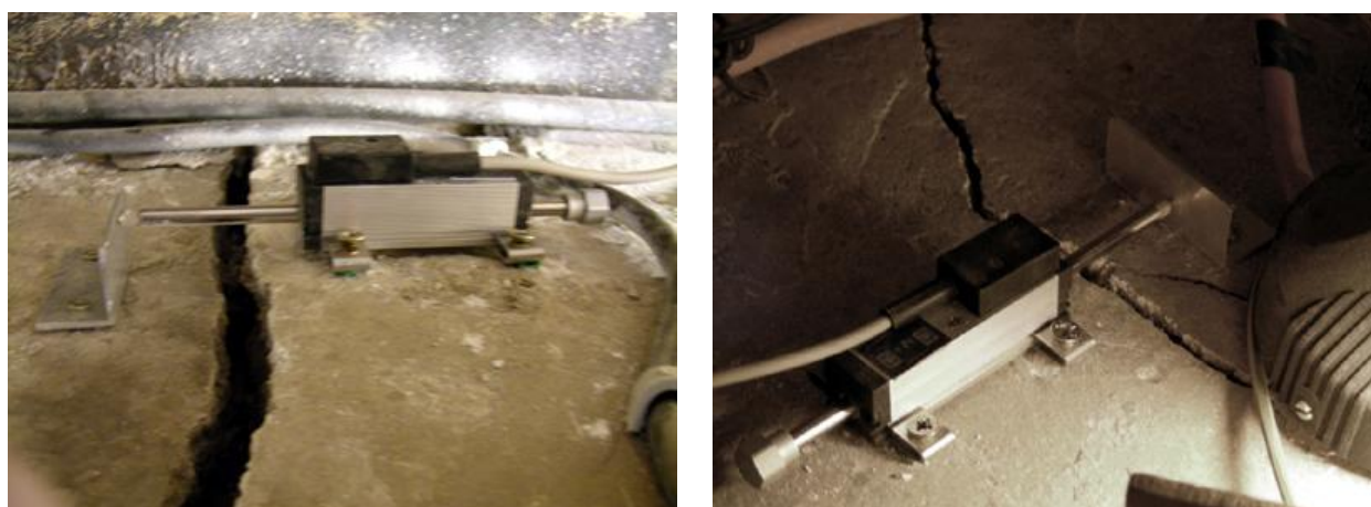
Figure 8: Fissures 1 et 2 instrumentées
