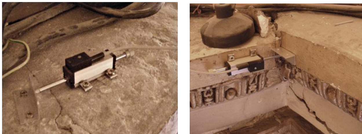
Figure 11 : Fissures 4 et 5 instrumentées.
