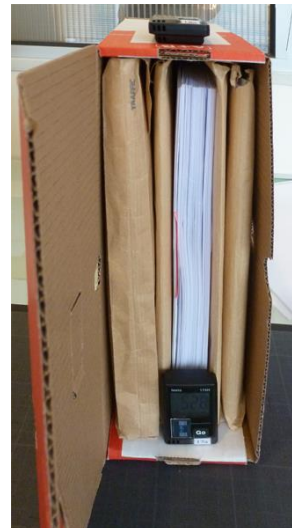
Fig.4 : Mini capteur HR/T dans boîte d'archives
