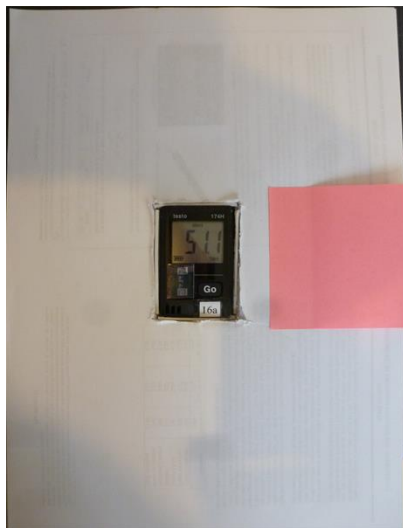
Fig.3 : insertion mini capteur HR/T dans ramette papier
