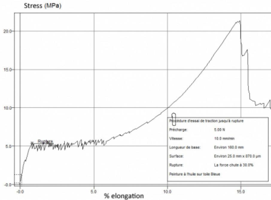
SoftwareNexygen (version 3). Tensile failure procedure (40/0640)
