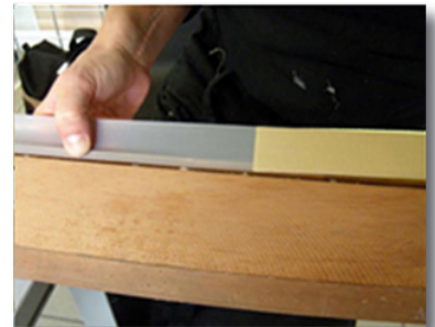
■ Fig 16 Mise en place du système S.T.A.R® sur un des châssis du triptyque – recouvrement de téflon. © Alain Roche.
