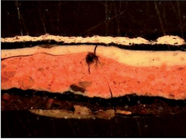
*Figure 25: Micro section d'une peinture montrant la propagation d'une fissure.*
