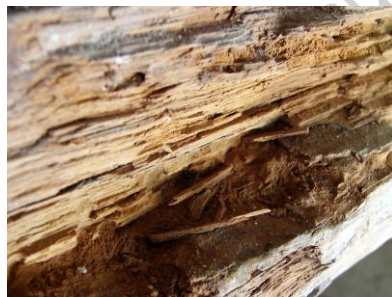
Fig.42 : Bois vermoulu de certaines poutres de la voûte.
