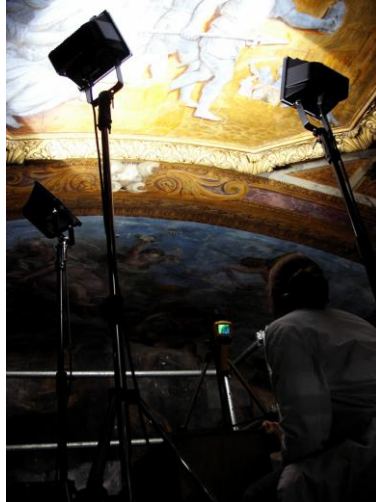
Fig.13 : Chauffage d'une surface à l'aide de lampes.
