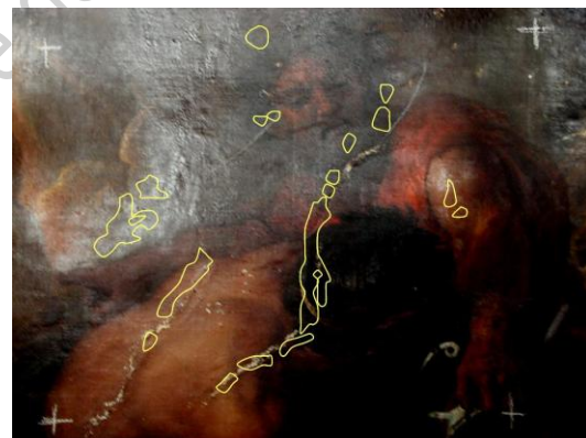
Fig.17 : Thermogramme d'une fissure fermée du tympan nord.
